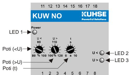
Bei Unterschreitung des am Potentiometer (**U<**) eingestellten Spannungsgrenzwertes
